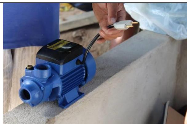
**Figura 35:** Bomba magnética com instalação de plug macho
